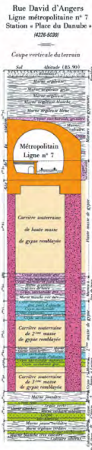
À gauche : coupe de terrain sous la rue David d'Angers, près des Buttes Chaumont (19 e ).
