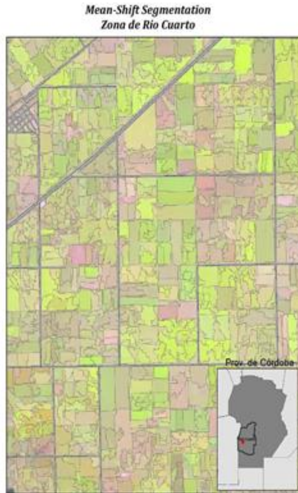
Figura 4. Ejemplo de mean-shift segmentation realizado en el área cercana a Río Cuarto.
