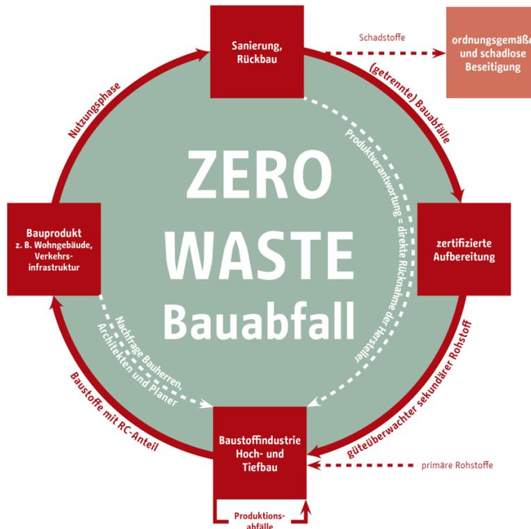
Abbildung 24: Zero Waste-Strategie für Bauabfälle (schematisch)
